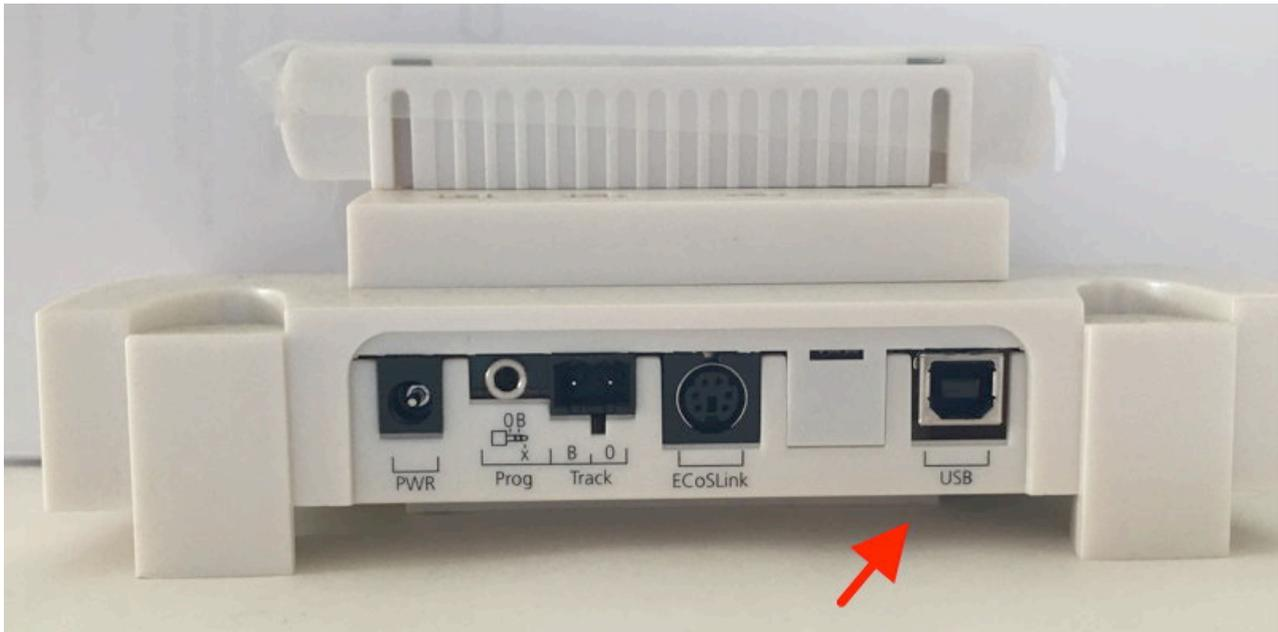
Nur wenn der Navigator (bzw. die "Dynamis Ultina") wie auf dem obigen Bild eine USB-Schnittstelle aufweist, kann eine Computeranbindung vorgenommen werden. Dazu ist dann ein USB-Druckerkabel erforderlich.
