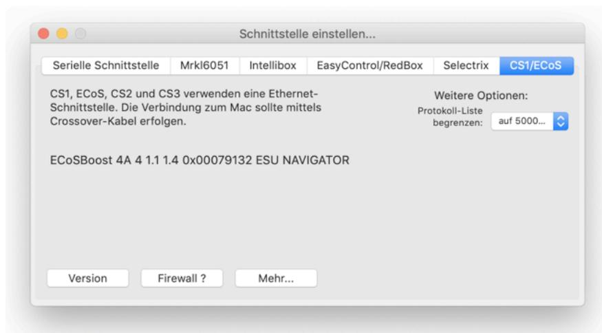
Der Button "Version" zeigt die Antwort des Navigators auf den Befehl "i 0" (siehe Bild oben). Der Button "Mehr..." zeigt die Antwort des Navigators auf den Befehl "s": Ampere, Volt und Temperatur (siehe Bild unten).
