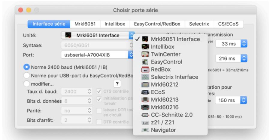
Der USB-Anschluss wird vom macOS als serielle Schnittstelle erkannt und in SDL in der Liste der verfügbaren seriellen Schnittstellen angezeigt. In SDL müssen die Einstellungen für eine serielle Schnittstelle vorgenommen werden, damit die Kommunikation stattfinden kann. Diese
